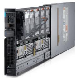
最大 16本のホットプラグSAS HDDを搭載可能なダイレクト接続 SAS ストレージスロット。最大 7台の「MX5016s」スロットがMX7000シャーシでサポートされます(シャーシあたり最大でDAS(直接接続ストレージ)を112本)。ドライブはデバイス単位でサーバーへ個別にマッピングできるので、ユースケースごとに、求められる最適なストレージ比率を実現できます。
