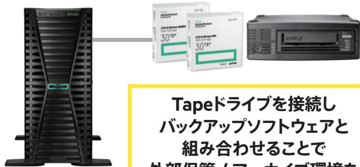
**Tapeドライブを接続しバックアップソフトウェアと組み合わせることで外部保管 / アーカイブ環境を安価に実現可能**
